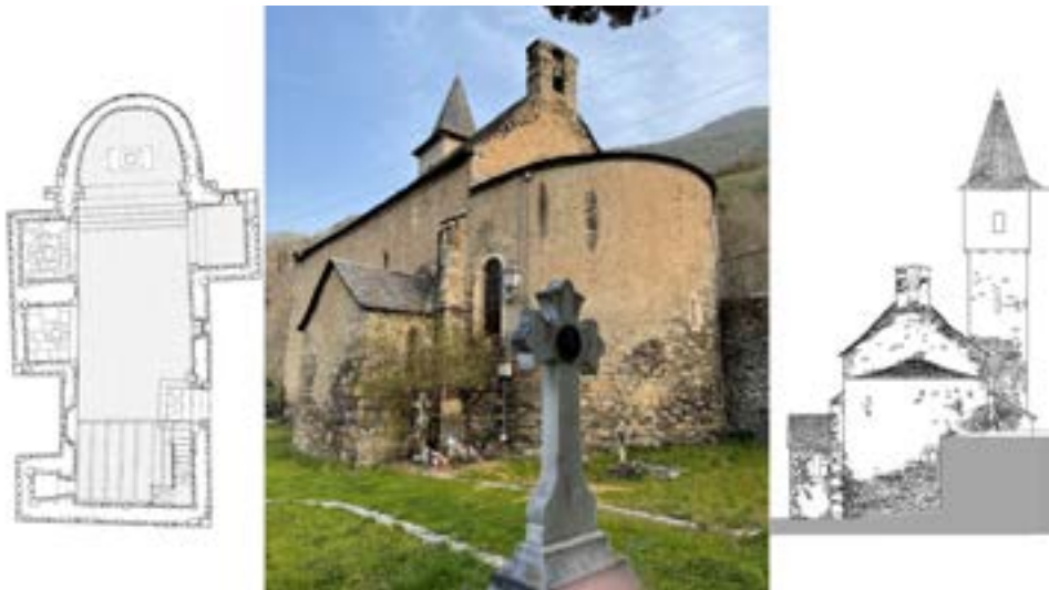
Figura 84. Sant Miquèu de Vilamòs [15]. a) Planta e seccions. b) Topografia des vòutes. Diferència geometrica entre es sòns trams en tot evidenciar era sua leugèra forma conoïda. c) Vòuta en sòn punt mèu naut envèrs ath son rigid arc de ressaut.
