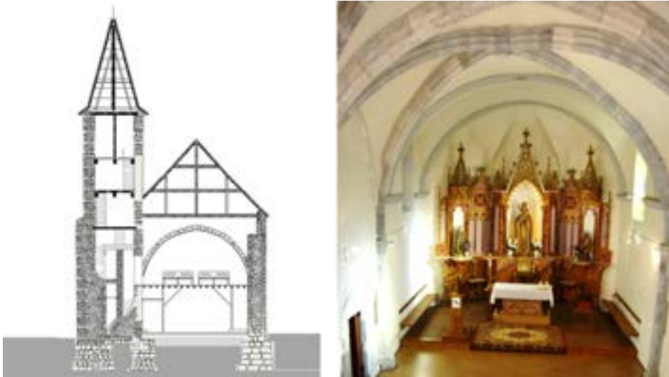
Figura 79. Vòutes de crotzilharia de Sant Martin de Tours de Gausac [26]
