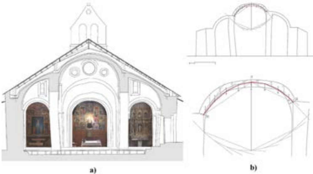
Figura 30. Santa Maria d'Arties, comprovacion dera estabilitat
