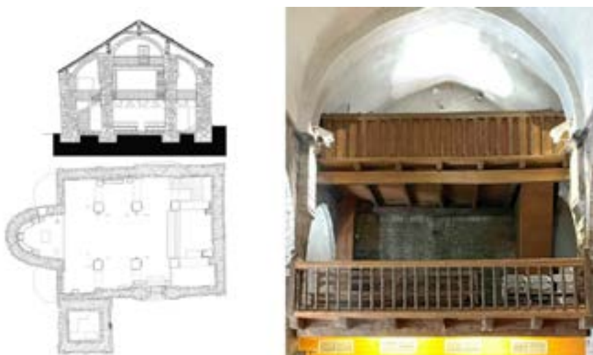
Figura 132. Planta e detalh dera seccion deth còr de balcon de dus nivèus d'Era Mair de Diu dera Purificacion de Bossòst [6]
