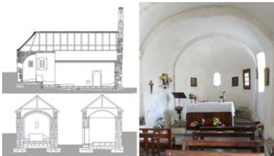
Figura 80. Vòuta rebaishada de Sant Fabian d'Arres de Jos [9]
