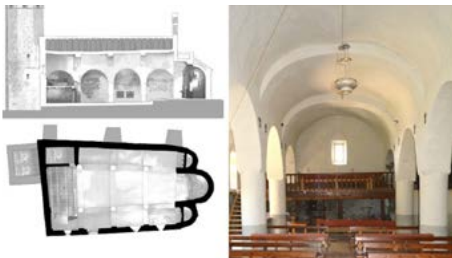
Figura 131. Planta e detalh dera seccion deth còr de balcon de Santa Eularia d'Unha [38]
