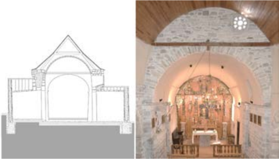
Figura 63. Coexistència de vòutes de maçonaria e cindres en Sant Fèlix de Bagergue [40]
