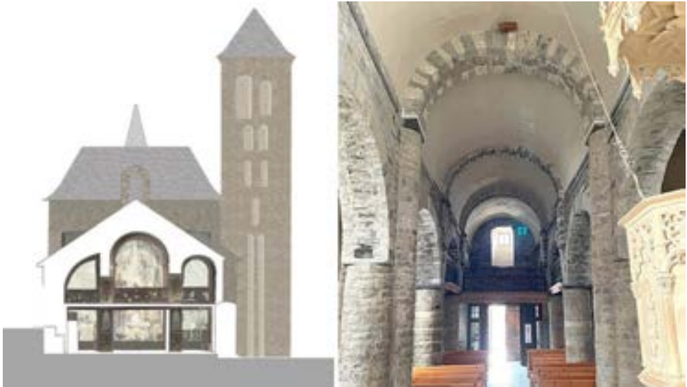
Figura 71. Seccion e vòuta de Santa Maria de Vilamòs [12]
