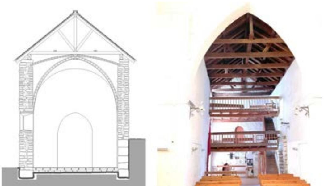
Figura 62. Cindres de husta de Sant Pèir d'Escunhau [31] sus eth primitiu còs romanic, coma ipotèsi d'un possible collapse estructurau.
